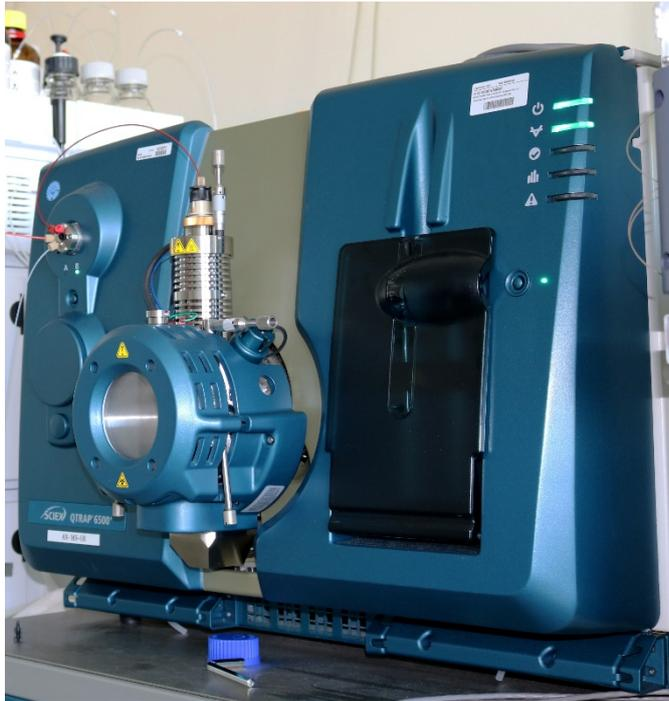
**Abb. 1** Mit dem Tandemmassenspektrometer lassen sich verschiedene Stoffe in der Tränenflüssigkeit auftrennen und lässt sich deren Konzentration bestimmen.
